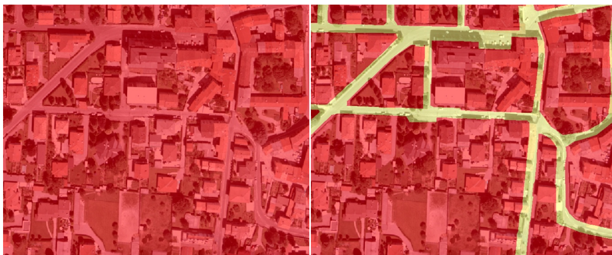
Estrazione delle geometrie delle strade e degli spazi accessori (comprese le aree per la sosta) dalle classi di uso del suolo del DUSAF 3.0
